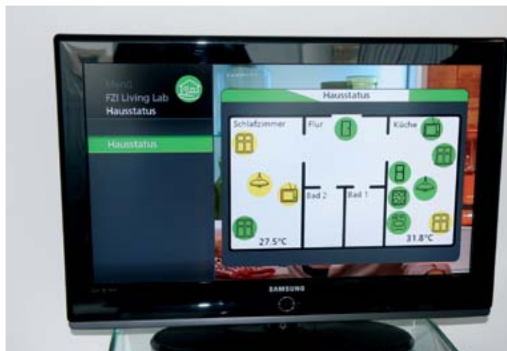
► Alle Haushaltsgeräte werden über den Fernseher überwacht
